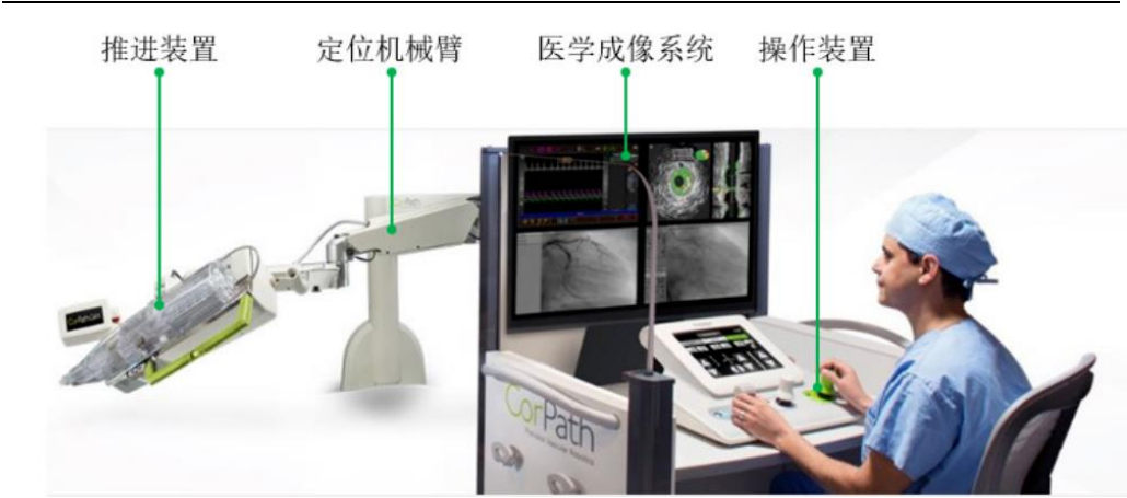
图 29：泛血管手术机器人构成
